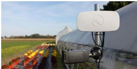
Das Gehäuse verfügt über den Schutzgrad IP55 beziehungsweise IP67. So können die Geräte sowohl im Innen als auch im Außenbereich eingesetzt werden.
