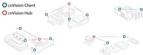
Für eine Punkt-zu-Punkt Verbindung können zwei cnvision Clients vom gleichen Typ (MICRO oder MINI) verwendet werden.
